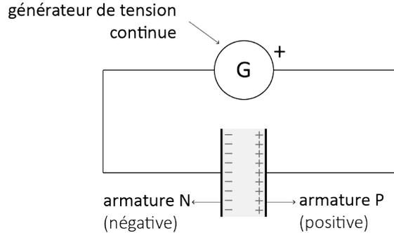
charges électriques de signes opposés, séparées par un matériau isolant.
