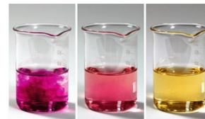
Doc.2 Décoloration progressive d'une solution de permanganate versée dans une solution d'acide oxalique.
