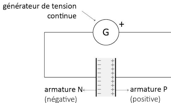
Champ électrostatique dans un condensateur plan :
