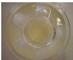
Erlenmeyer dans la glace avant ajout d'acide
