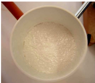
Filtrage sur Büchner du solide obtenu
