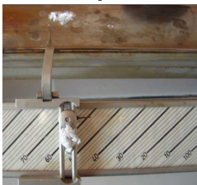
Étalonnage du banc de Köfler à 159°C
