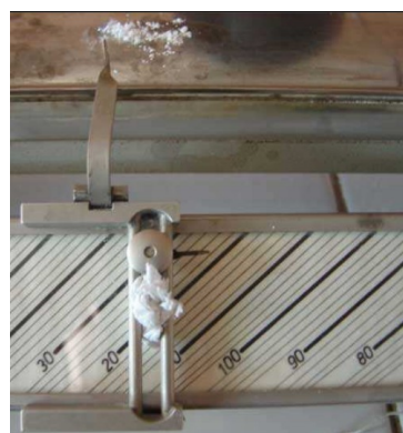
Lecture de la température de fusion du produit
