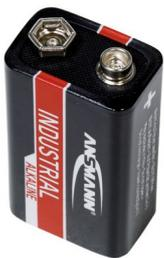
Lorsqu'une pile débite un courant électrique d'intensité  $200 \text{ mA}$ , la tension à ses bornes vaut  $8,7 \text{ V}$  et lorsque rien n'est branché à ses bornes, la tension électrique aux bornes de cette pile est de  $9,0 \text{ V}$ .
